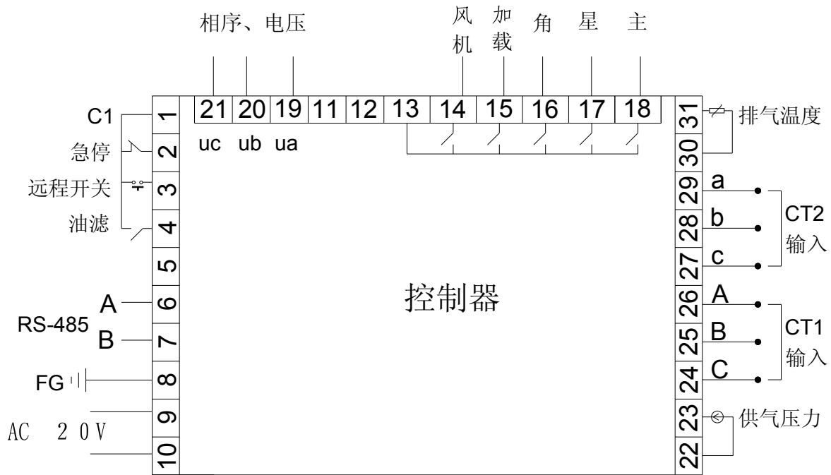
图 4.2.1、接线端子排列图
